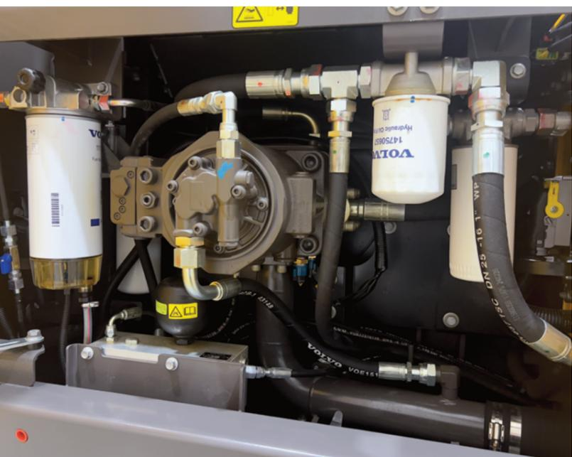
**RISPOSTA RAPIDA E PRECISA** L'elettronica controlla pressione, portata e giri delle pompe, ottimizzando l'efficienza e prevenendo sovraccarichi. Le pompe K7V riducono inoltre la rumorosità di funzionamento e le vibrazioni, rispetto a quelle di generazione precedente sono più longeve grazie ad un'usura inferiore.
