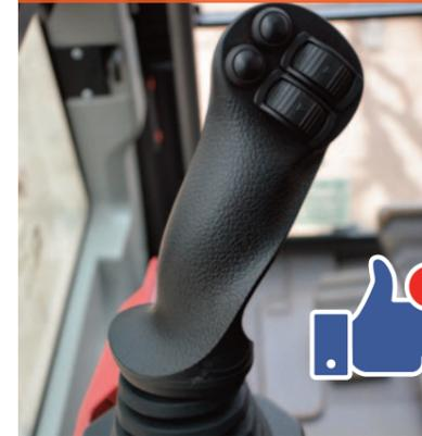
**JOYSTICK ELETTRICI L8** L'allestimento standard per l'Italia dell'EC230 include i nuovi joystick ergonomici che permettono la configurazione di 8 funzioni ciascuno, anche grazie alla pressione rapida o prolungata degli stessi tasti. Le nuove leve di comando «Low-effort» sono progettate per richiedere movimenti contenuti e uno sforzo molto ridotto da parte dell'operatore in modo da ridurre l'affaticamento muscolare, soprattutto durante turni lunghi o operazioni di precisione ripetute.
