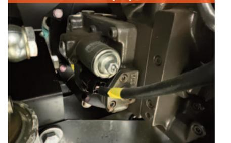
**MODALITÀ CREEP** La si attiva per avviare e arrestare la traslazione dolcemente con l'obiettivo di semplificare applicazioni di sollevamento pick and carry. In sostanza, l'elettronica disattiva la sommatoria tra le due pompe principali da 208 l/min. Una pompa è così dedicata alla sola traslazione, regolabile su cinque livelli, mentre l'altra è dedicata all'attrezzo.
