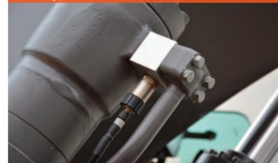
**ELETTRONICO** Il solenoide qui sotto è uno di quelli che permettono di regolare dinamicamente la portata delle pompe.
